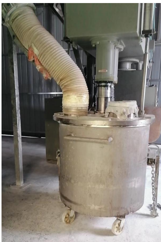
塑料软管密封连接；密闭式搅拌罐
